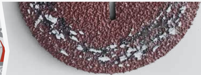
Mit Aluminiumspänen zugesetzte Fiberscheibe
