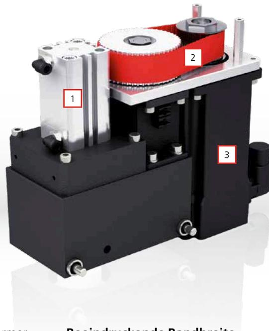
Der elektronische S-Former E besteht aus Formerkopf mit Servomotor und SPS-Steuerung. Diese kann bis zu vier Formerköpfe steuern und permanent überwachen, was für höchste Gewindegüte und Prozesssicherheit sorgt.
